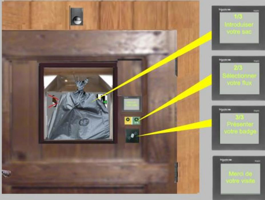
Processus du mécanisme.
